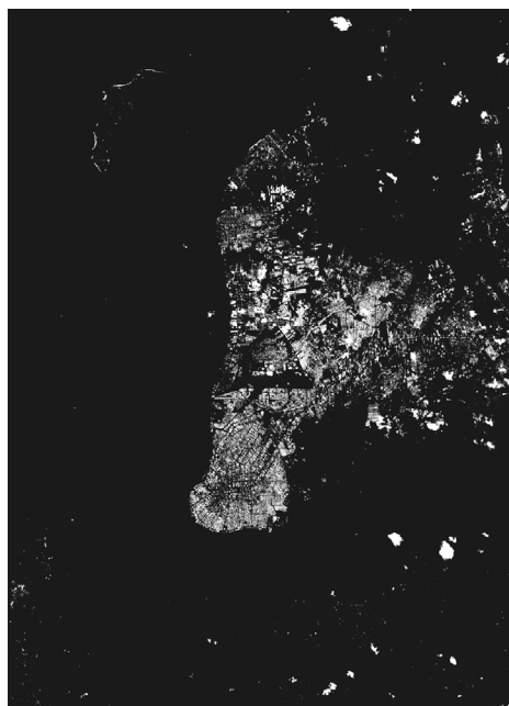
Figura 8. Índice de textura calculado a partir de una imagen de Landsat clasificada en Belém, Brasil
