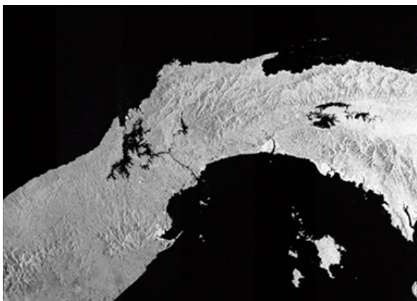
Figura 2. Imagen TerraSAR-X del canal de Panamá, tomada en modo WideScanSAR, órbita descendente, polarización HV a un ángulo de incidencia de 29° el 12 de julio de 2013
